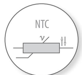
Ein NTC ermöglicht eine temperaturabhängige Schaltfunktion. Dadurch kann das Schaltsignal bis zum Erreichen einer Betriebstemperatur übersteuert werden, um z. B. die Verschmutzungsanzeige am Filter bei tiefen Temperaturen zu umgehen.
