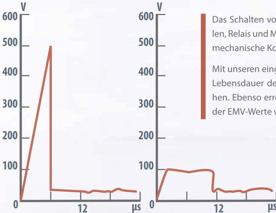
Das Schalten von induktiven Lasten, wie z.B. Ventilen, Relais und Motoren ist eine Herausforderung für mechanische Kontaktsysteme und Mikroschalter.
